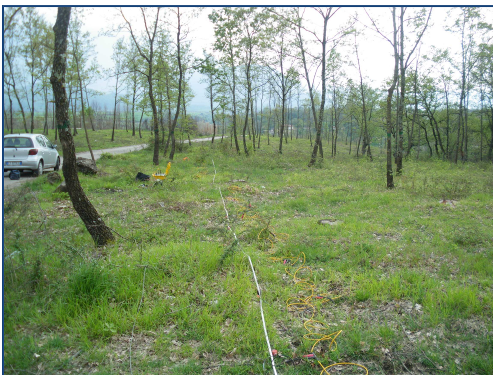
Foto n.19 – Prospezione sismica MASW n. 9 – Località Tito
