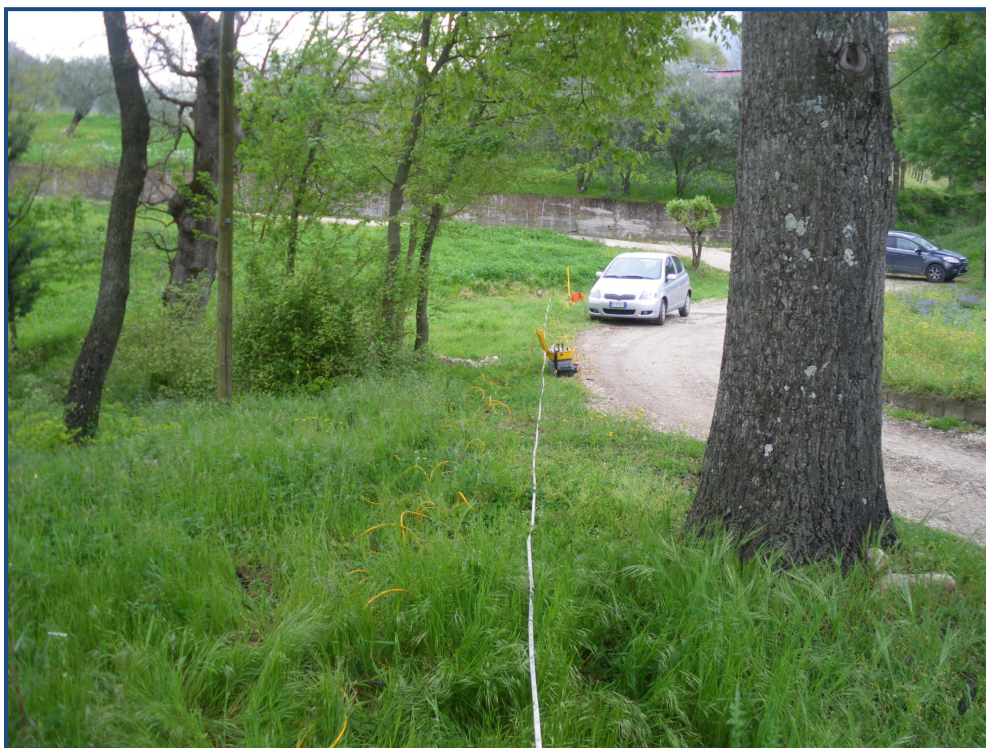
Foto n.13 – Prospezione sismica MASW n. 3 – Località Vonghia.
