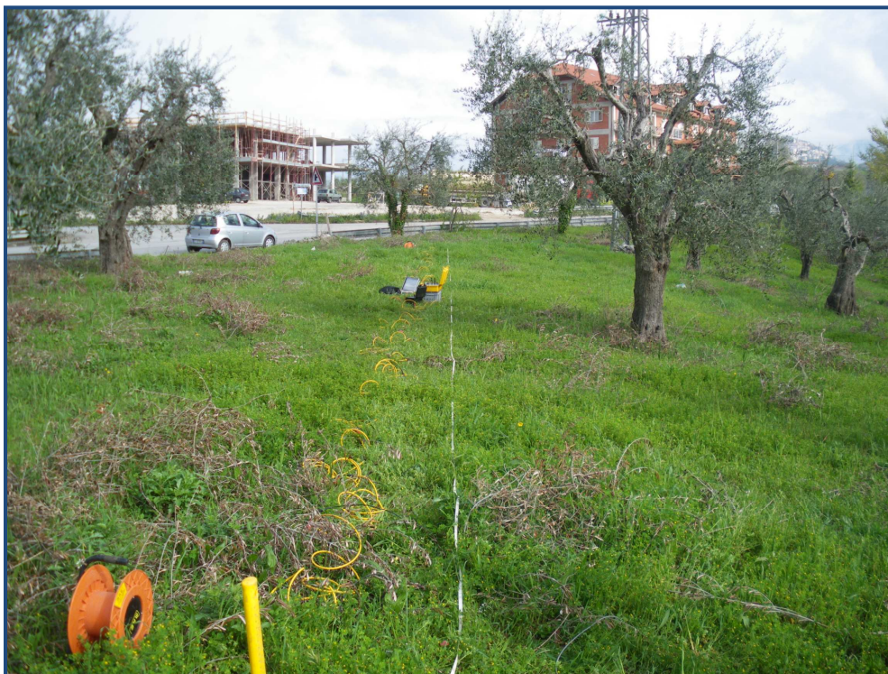
Foto n.20 – Prospezione sismica MASW n. 10 – Località Monte di Pruno – SP36
