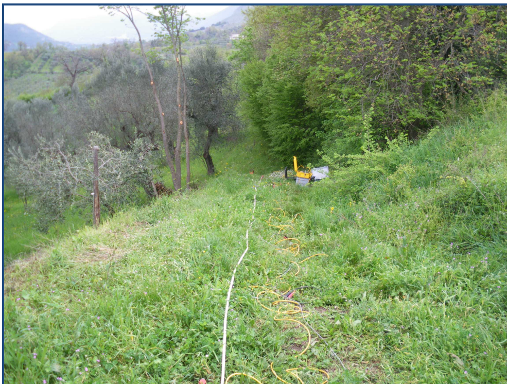
Foto n.17 – Prospezione sismica MASW n. 7 – Località Padula
