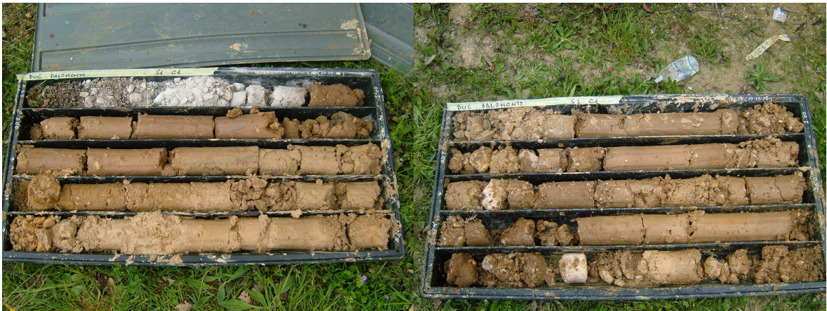
Foto n.9: cassette catalogatrici s1-s2 (sabbie argillose con trovanti)
