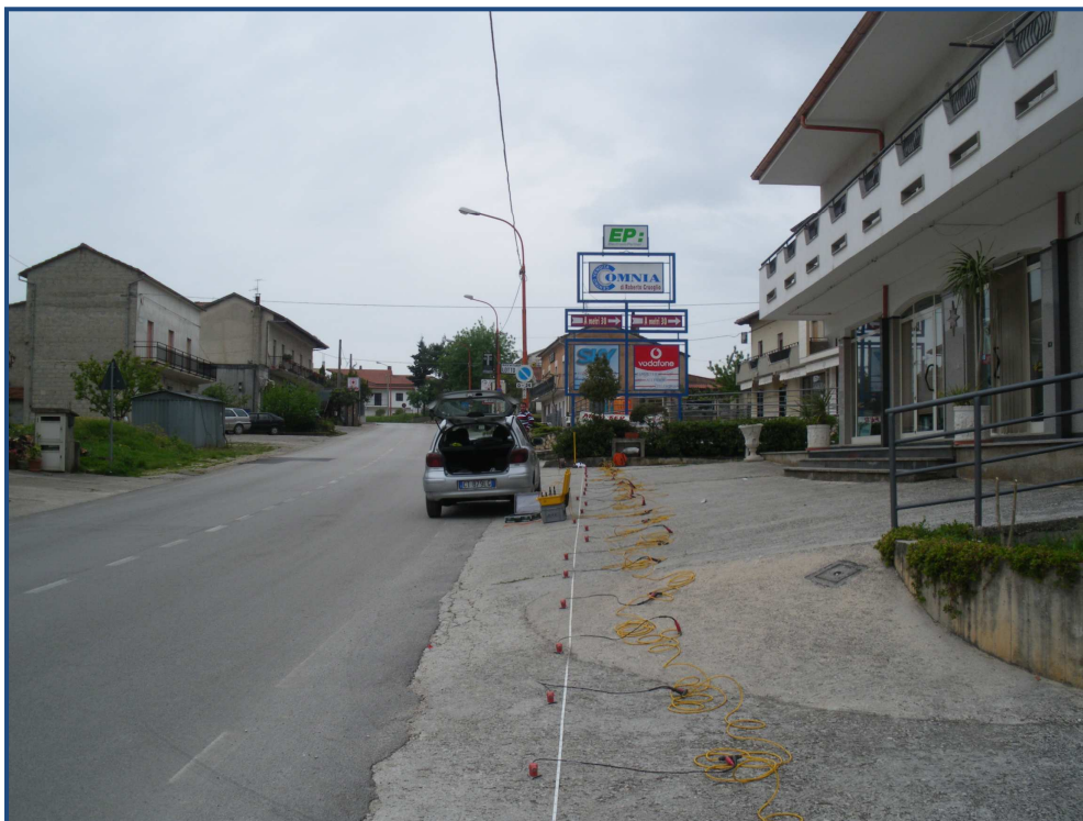
Foto n.14 – Prospezione sismica MASW n. 4 – Località Perrazze
