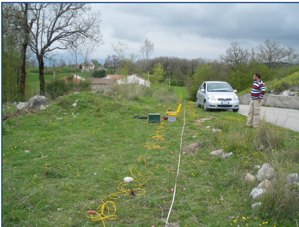
Foto n. 16 – Prospezione sismica MASW n. 6 – Località Arigliulo.
